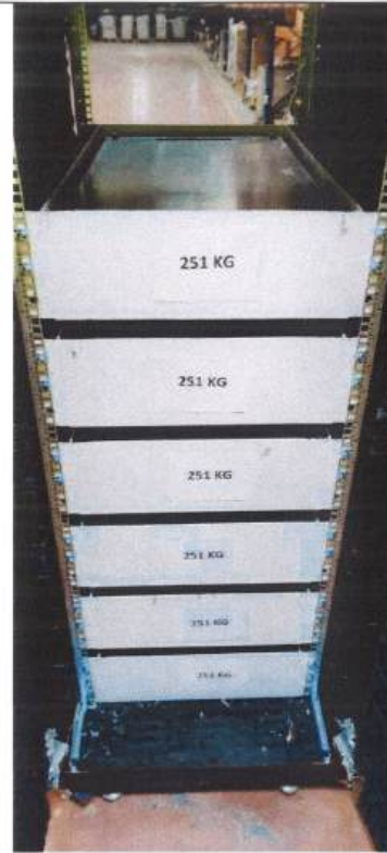
32 U (W=750X,D=1130x H=1666) Cabinet static load test
