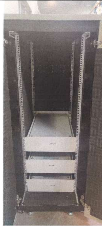
32 U (W=750X,D=1130x H=1666) Cabinet dynamic load test
