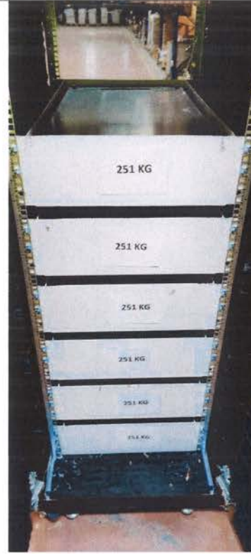
32 U (W=750X,D=1130x H=1666) Cabinet static load test
