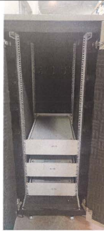
32 U (W=750X,D=1130x H=1666) Cabinet dynamic load test
